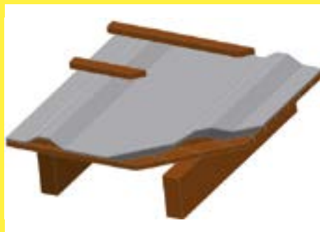
Na debnení – nezateplené podkrovie.
