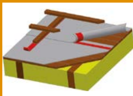
Na debnení – zateplené podkrovie.
