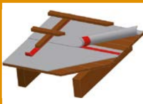
Na debnení – nezateplené podkrovie.
